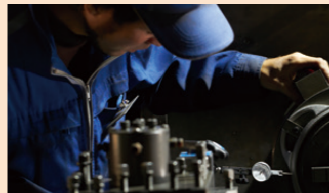
職人の経験で叩いたときの音の違い、指先の振動を感じながら、一品一品調整して3mmの鑄物を0.01mm以下の精度まで削る
